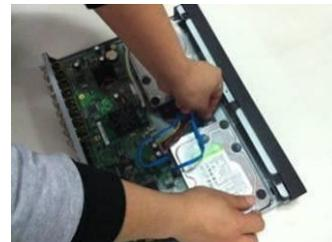
⑥ Connectez le câble du disque dur et le câble d'alimentation.
