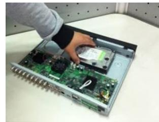
③ Aligned le disque dur avec les quatre trous du bas.
