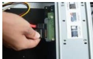
⑥ Connectez le câble d'alimentation du disque dur, puis remettez le couvercle en place. Vissez fermement.
